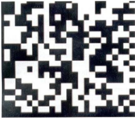
**Bild 2: DMC des Typs ECC 200 nach ISO/ IEC 16022**
