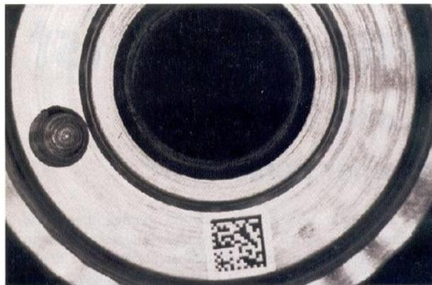
**Bild 3: DMC auf einem Motorenteil**
